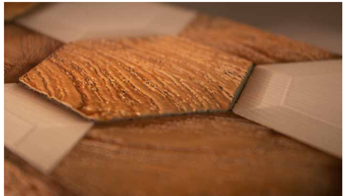
Deze geprinte houtstructuur geeft goed de meerwaarde aan voor toepassing in interieurs.
